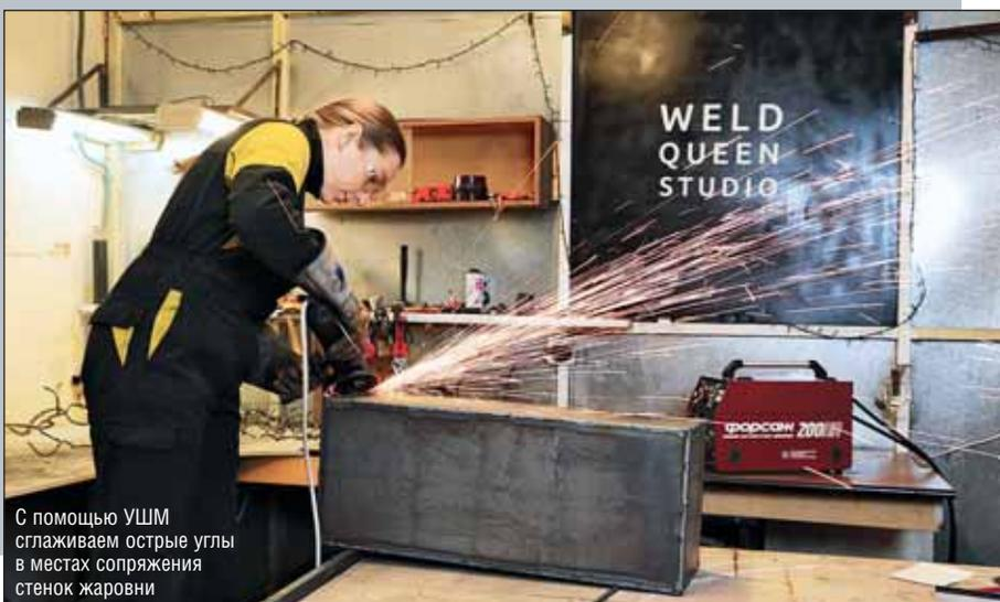
С помощью УШМ сглаживаем острые углы в местах сопряжения стенок жаровни
