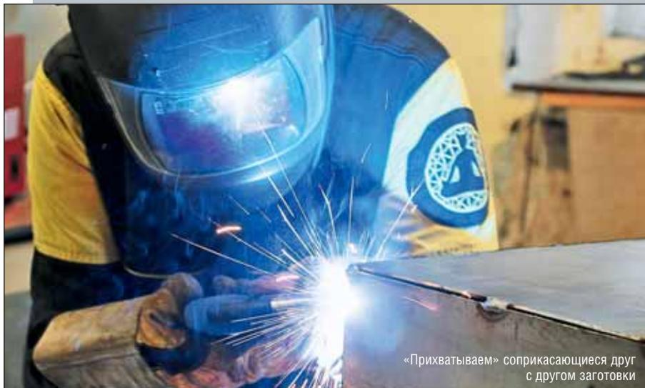
«Прихватываем» соприкасающиеся друг с другом заготовки
