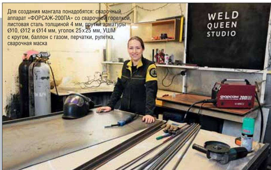
Для создания мангала понадобятся: сварочный аппарат «ФОРСАЖ-200ПА» со сварочной горелкой, листовая сталь толщиной 4 мм, прутки арматуры Ø10, Ø12 и Ø14 мм, уголок 25x25 мм, УШМ с кругом, баллон с газом, перчатки, рулетка, сварочная маска
