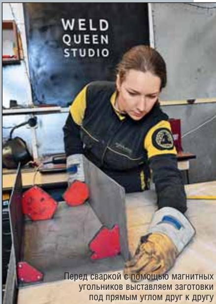
Перед сваркой с помощью магнитных угольников выставляем заготовки под прямым углом друг к другу
