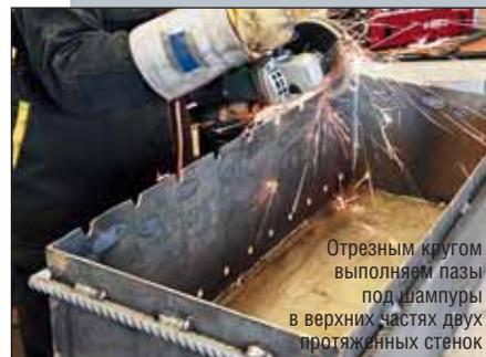
Отрезным кругом выполняем пазы под шпильки в верхних частях двух протяженных стенок
