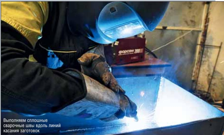
Выполняем сплошные сварочные швы вдоль линий касания заготовок
