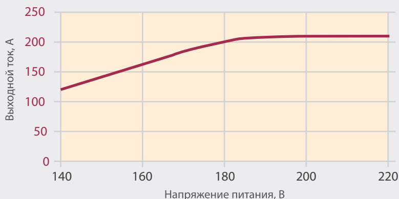
Зависимость величины максимального выходного тока от величины питающего напряжения для сварочных аппаратов Форсаж-200 и Форсаж-200М
