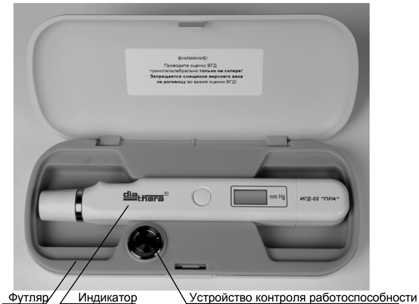
Рисунок 2 – Внешний вид индикатора в футляре
