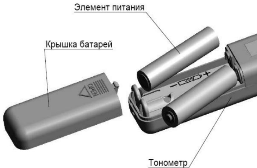
Рисунок 2 – Установка элементов питания
