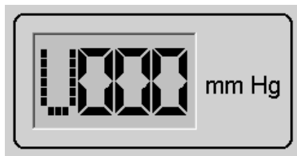
Рисунок 4 – Индикация разряда элемента питания
