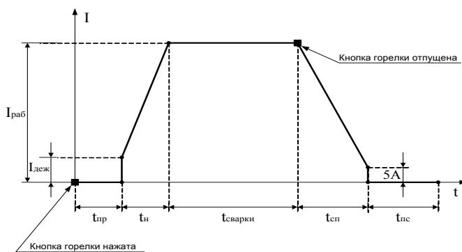
$I_{раб}$ , А – величина сварочного тока, устанавливаемая регулятором аппарата «-»-«+»
