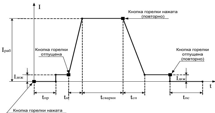
$I_{раб}$ , А – величина сварочного тока, устанавливаемая регулятором аппарата «-»-«+»
