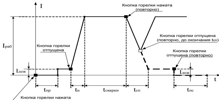
При условии повторного отпускания кнопки в течение времени спада тока до снижения значения сварочного тока до величины  $I_{деж}$  (до окончания времени  $t_{cн}$ ), происходит возврат значения сварочного тока к значению  $I_{раб}$ . Для завершения сварки после возврата к рабочему значению тока, необходимо еще раз нажать кнопку горелки и отпустить ее после окончания спада тока до величины  $I_{деж}$ .
