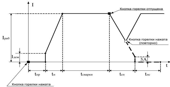
При условии повторного нажатия кнопки в течение времени спада тока до окончания времени  $t_{cн}$  происходит возврат значения сварочного тока к значению  $I_{раб}$ . Для завершения сварки после возврата к рабочему значению тока, необходимо еще раз отпустить кнопку горелки и дождаться окончания спада тока.
