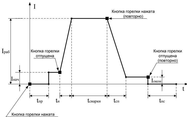
$I_{раб}$ , А – сварочный ток, устанавливаемый регулятором аппарата «-»-«+»;
