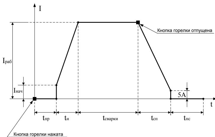
$I_{\text{раб}}$ , А – значение сварочного тока, устанавливаемое регулятором аппарата «-»-«+»;
