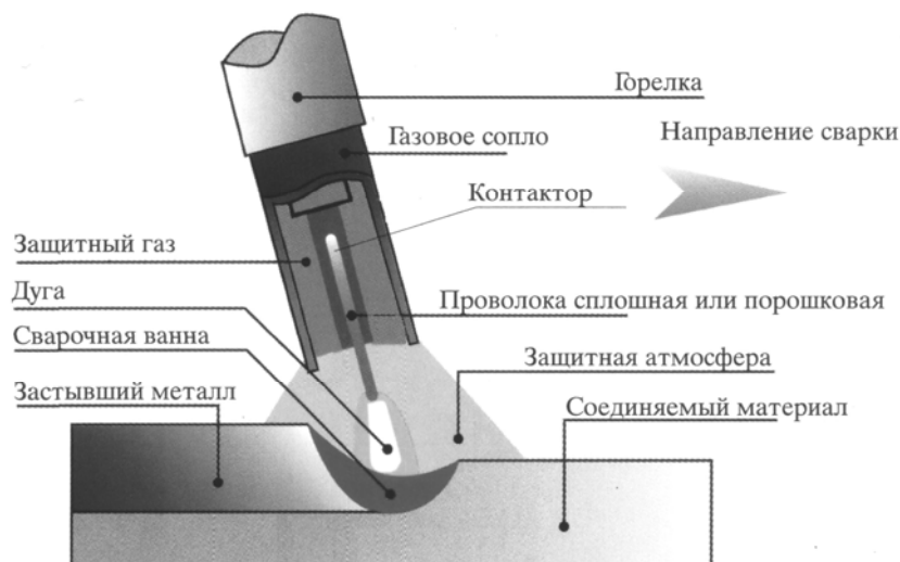
Рис. 5.1. Полуавтоматическая сварка в среде защитного газа.
