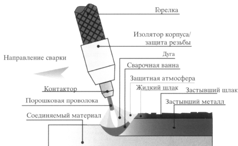
Рис. 5.4. Сварка самозащитной порошковой проволокой.
