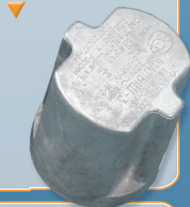
Изделие «Крышка насоса «Малыш» Форма двухместная
