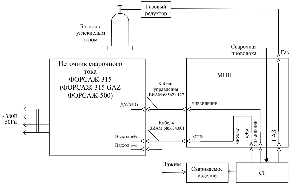
Рисунок 5 - Схема рабочего места для сварки в полуавтоматическом режиме
